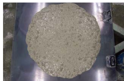
スランプフロー試験(高い流動性)
